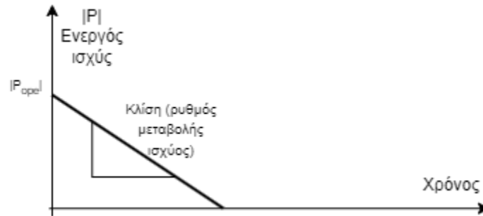
Σχεδιάγραμμα Δ5.14 : Χαρακτηριστική καμπύλη ρυθμού μείωσης της Ενεργού Ισχύος κατά την αποσύνδεση του Συστήματος Αποθήκευσης
