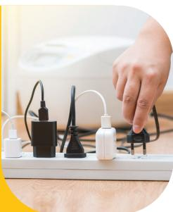
Αποφεύγουμε όσο το δυνατό περισσότερο τη χρήση πολύπριζων. Αν είναι αναγκαίο, το χρησιμοποιούμε μόνο για τροφοδότηση μικρής ισχύος συσκευών.
