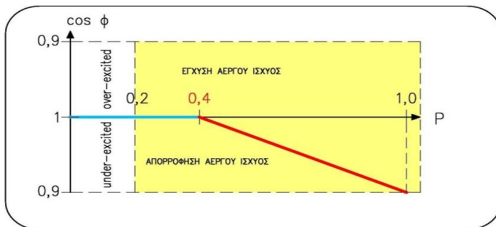
ΣΧΕΔΙΑΓΡΑΜΜΑ 3: Χαρακτηριστική καμπύλη διακύμανσης του συντελεστή ισχύος σε συνάρτηση με την μεταβολή της Φ/B παραγωγής ενεργού ισχύος (COSF(P))
