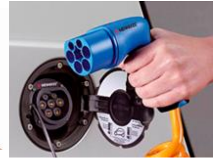
TYPE 2 (φόρτιση AC) 3/7/21/43kW
